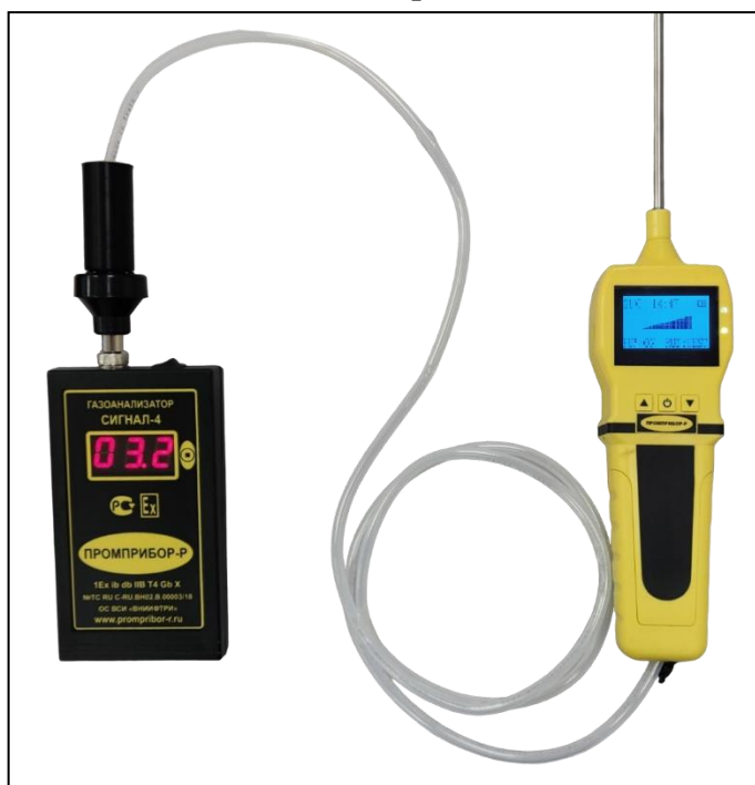
Рис. 3. – Подключение зонда к газоанализатору Сигнал-4.
