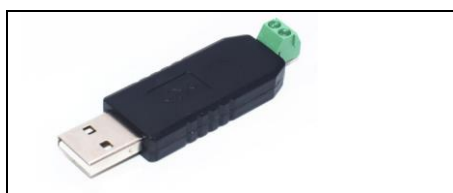
Рис2. конвертер USB к RS485
