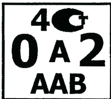
Рисунок А.4 - Поверительное клеймо, применяемое метрологической службой юридического лица при клеймении средств измерений, находящихся в эксплуатации или после ремонта
